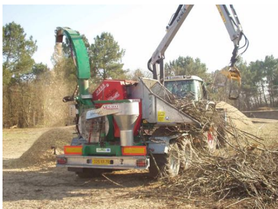
Déchetage de haie bocagère par déchiqueteuse à grappin / Source : FD CUMA 72
