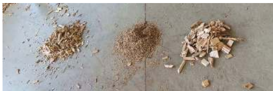
Trois fractions granulométriques séparées par criblage
