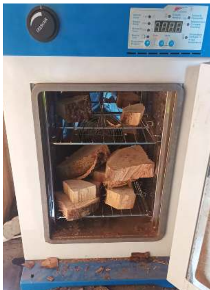
Contrôle de l'humidité à l'étuve
